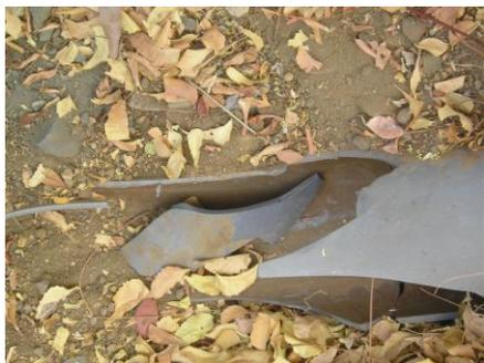
Fig.1.8 Tubería de 6" PVC SDR 26
