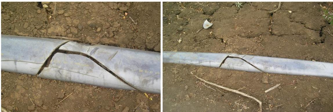
Fig. 1.2 y Fig.1.3 Estado actual de la tubería de conducción.
