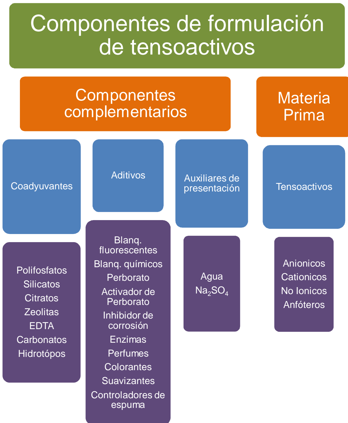
Figura 1. Esquema de componentes básicos que presenta la formulación de los detergentes, donde se presenta como principal materia prima tensoactivos o surfactantes.
