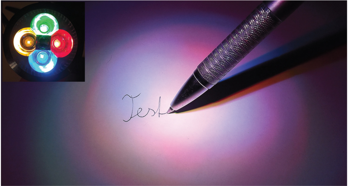
Obr. 5.15: Samostatné LED s kolimátorem.
