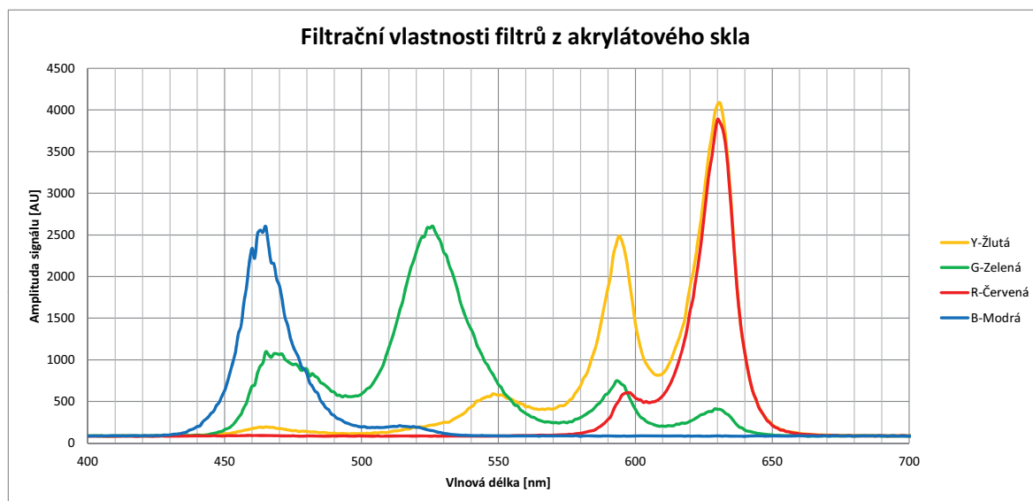
Obr. 7.9: Filtrační vlastnosti akrylátového skla pro RGBY model.
