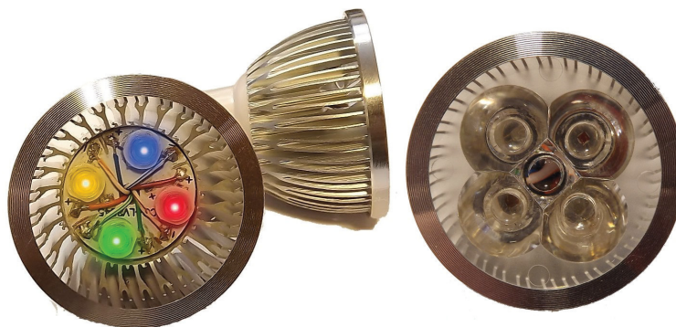
Obr. 5.12: Konstrukce RGBY svítidla - přestavba stávajícího zdroje osvětlení výměnou LED.
