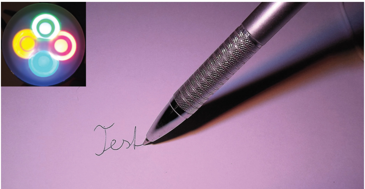
Obr. 5.16: Samostatné LED s kolimátorem a difuzorem.
