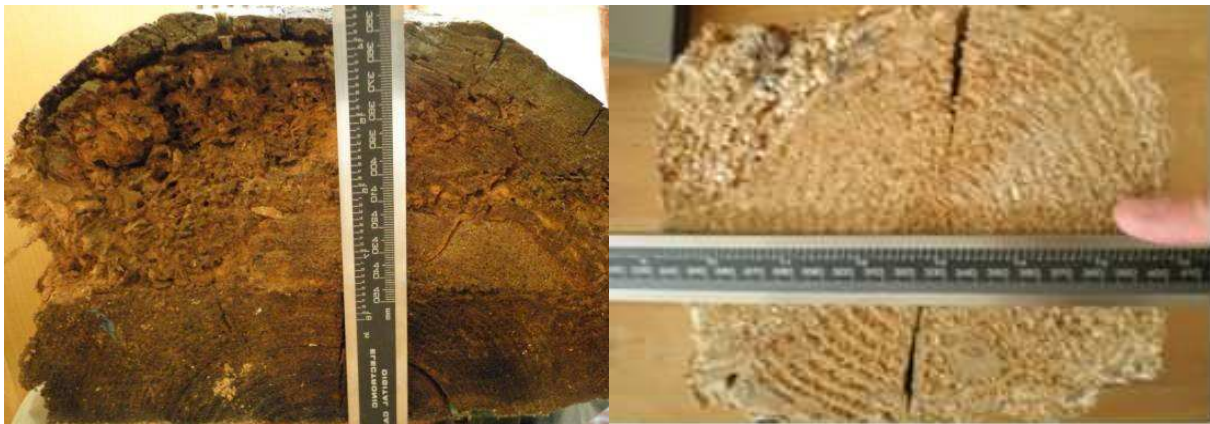
Obr. 18 Příklad testovaných vzorků původních konstrukčních profilů: a) degradovaný stropní trám, b) prvek s vysušnými trhlinami
