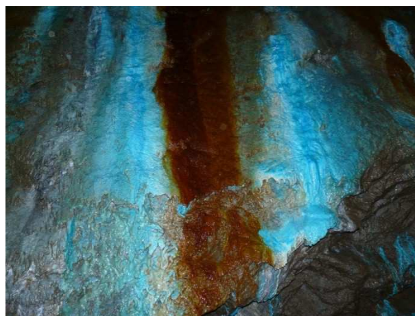
Obr. 19 Depozice alofánů na důlních stěnách a prvcích výdřev – Modrá štola, Zlaté hory
