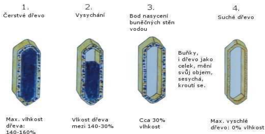
Obr. 14 Vlhkost v buňkách dřeva a vlhkostní objemové změny [73]
