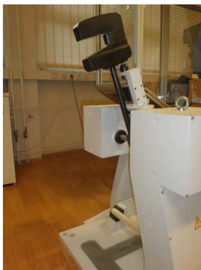
Obr. 61 Stanovení rázové houževnatosti malých bezvadých vzorků v Charpyho kladivu
