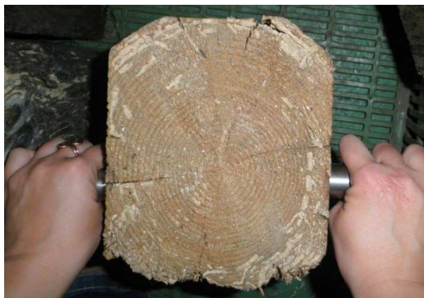
Obr. 37 Měření s přístrojem Pundit LAB (přiložení sond k povrchu vzorku)
