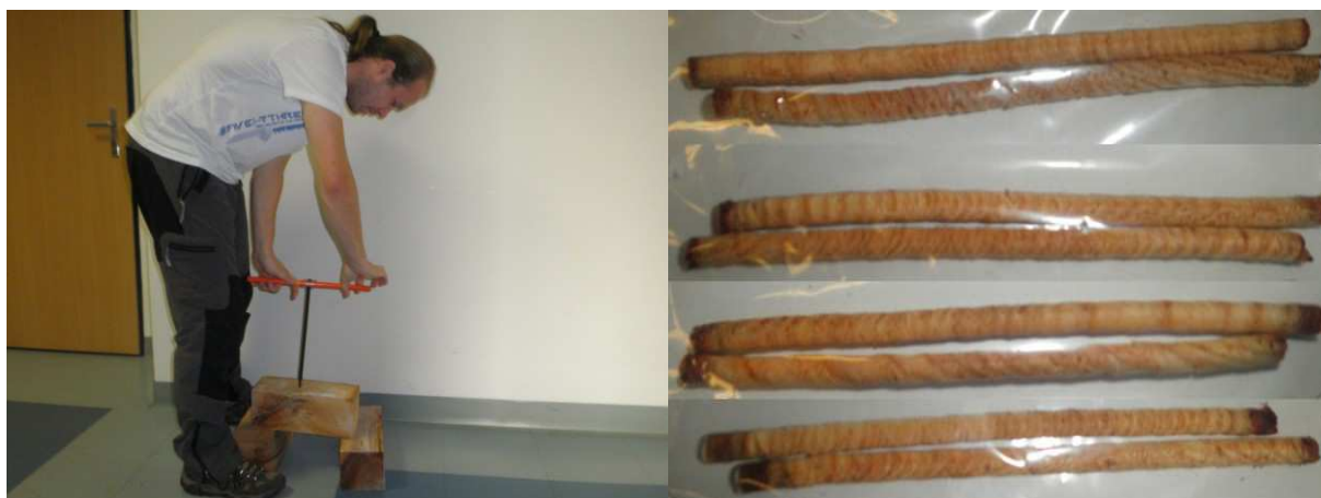
a) b) Obr. 26 Přírůstkový vrták: a – realizace odběru vzorku, b – odebrané vzorky
