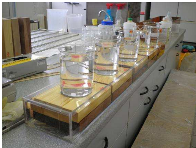
Obr. 47: Experimentální fáze č. 4 – aplikace roztoku hydrofobizátoru máčením
