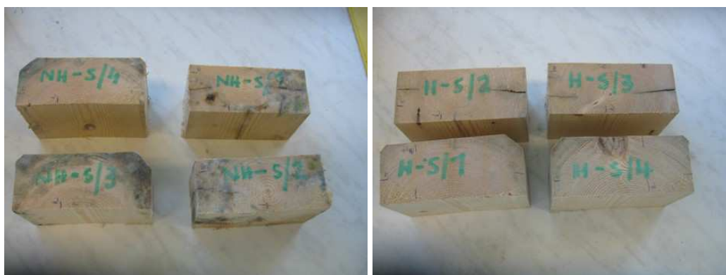
Obr. 50: Experimentální fáze č. 2 – na povrchu neošetřených vzorků (vlevo) dochází k rozvoji růstu plísní
