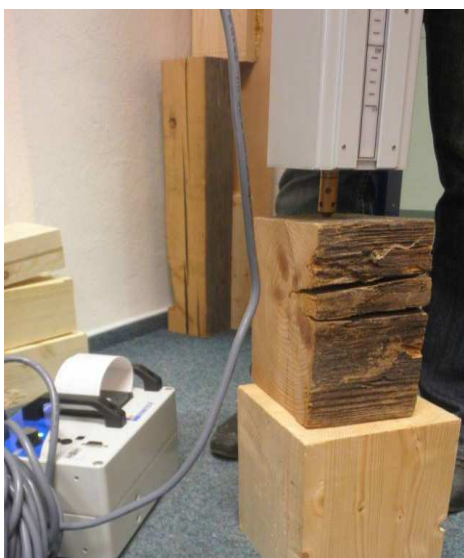
Obr. 39 Měření s přístrojem Resistograph 4453-P
