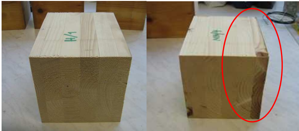
Obr. 51: Vzorky LLD po provedení 3. experimentální fáze: a – hydrofobizovaný vzorek bez opticky viditelných vlhkostních stop; b – nehydrofobizovaný vzorek se zřetelným nasycením kontaktní lamely vodou (lamela vyznačena červeně)
