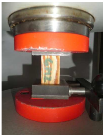
Obr. 58 Stanovení pevnosti dřeva v tlaku podél vláken u malých bezvadých vzorků
