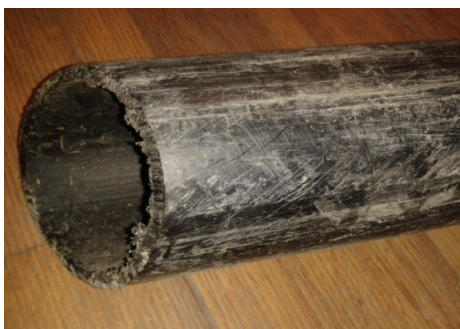
Obr. 2: LITEN PL 10 vyjmutý ze země při rekonstrukci (foto autor)
