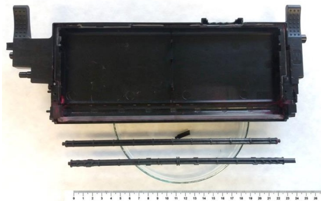
Obr. 20 Podíl plastů - ABS-GF5
