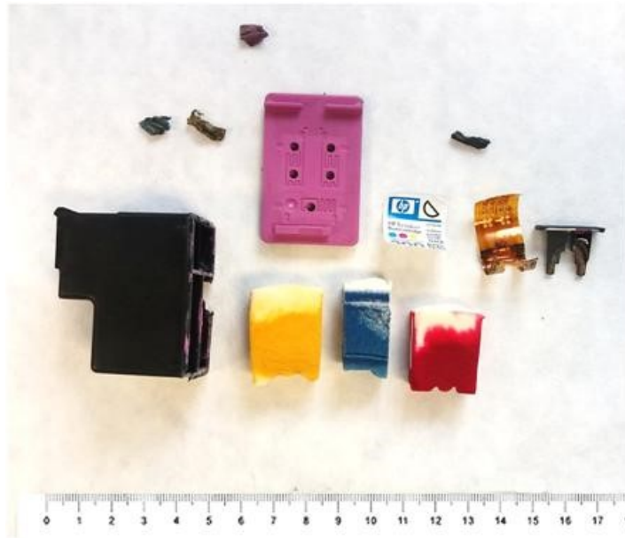
Obr. 34 Oddělené konstrukční složky z inkoustové cartridge HP
