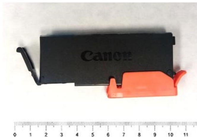
Obr. 40 Inkoustová kazeta značky Canon v nerozebraném stavu
