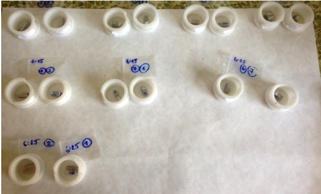
Obr. 22 Vzorky připraveny na zalití do plastu
