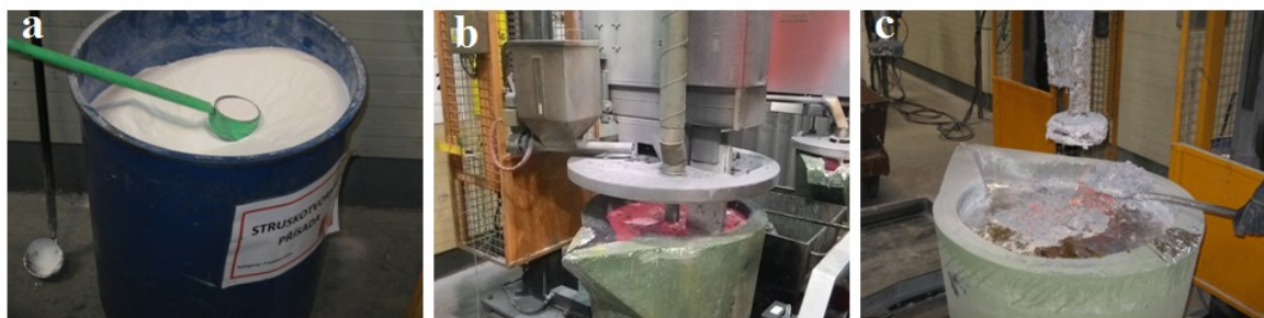
Obr. 20 Proces odplynění – a) rafinační sůl, b) odplynění a naplynění, c) stahování strusky z povrchu taveniny
