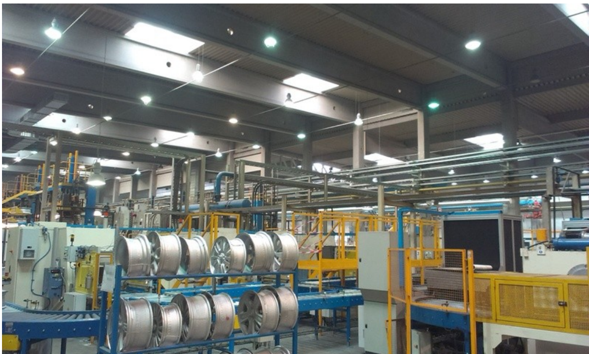
Obr. 18 Výrobní linka kol ze slitin hliníku pro automobily
