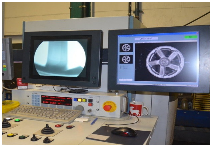
Obr. 12 RTG kontrola odlitků kol [18]
