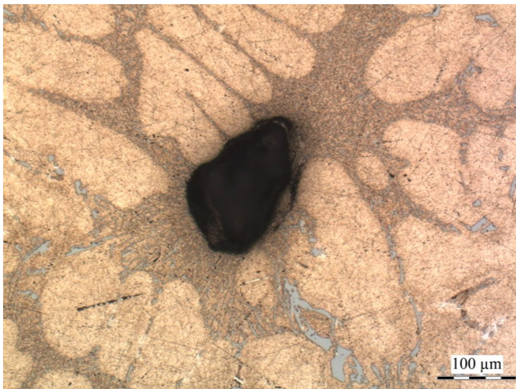
Obr. 37 Podélný řez – vzorek F, pór
