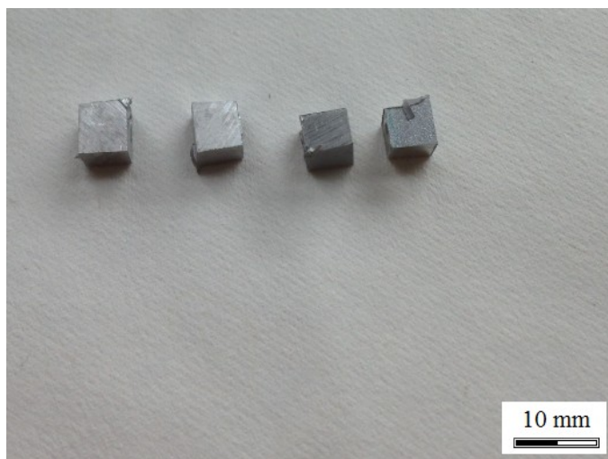
Obr. 26 Výsledné krychle pro analýzu obsahu vodíku
