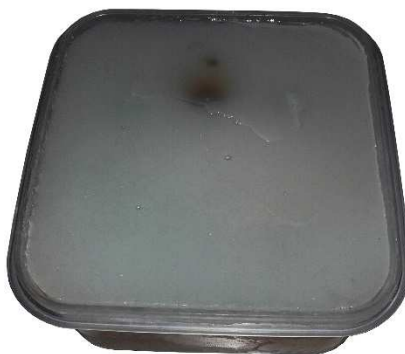
Obr. 4-4. Původní fantom na bázi agaru
