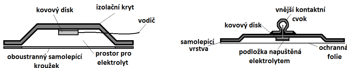
Obr. 3-1 Plovoucí elektroda ve dvou různých provedeních.
