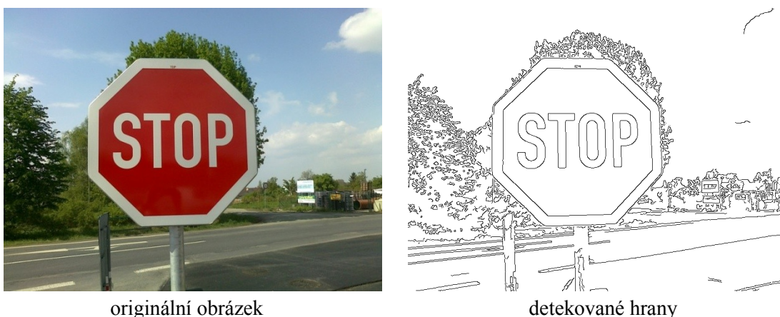
Obrázek 4.5: Detekované hrany pomocí Cannyho hranového detektoru
