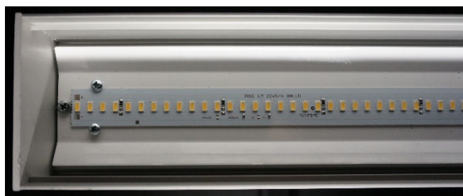
Obr. 22 Lineární LED modul v lineárním svítidel firmy INGE Opava
