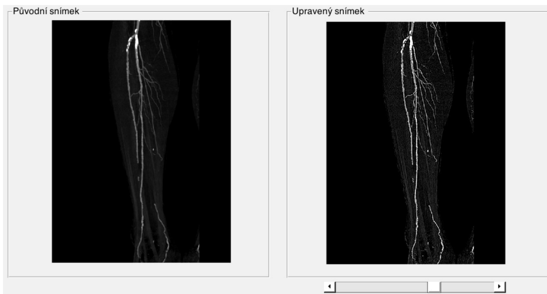
Obrázek 33 – Ukázka funkce filtrování hran. Vlevo: Původní snímek. Vpravo: Upravený snímek po filtraci hran pomocí zvýšení stupně ostrosti.
