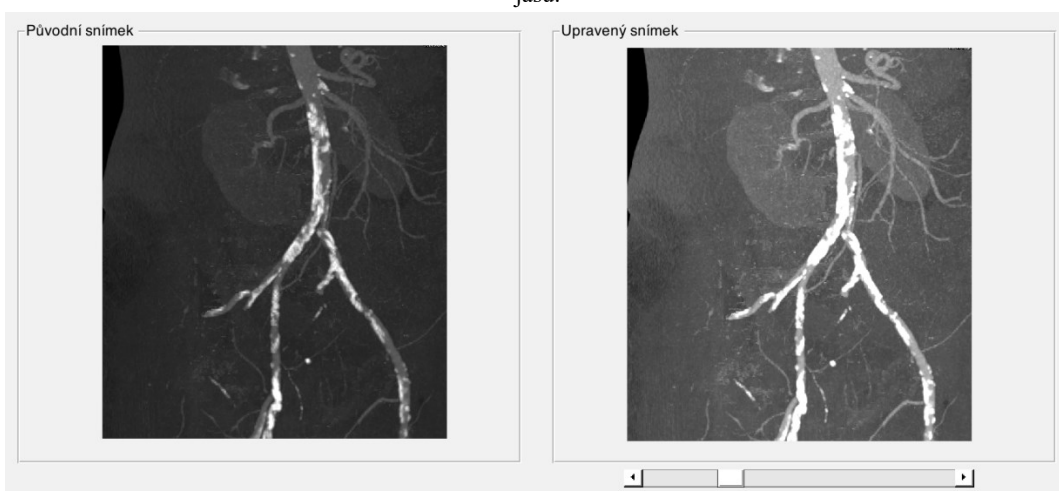
Obrázek 31 – Ukázka funkce korekce/změny kontrastu. Vlevo: Původní snímek. Vpravo: Upravený snímek po zvýšení úrovně kontrastu.
