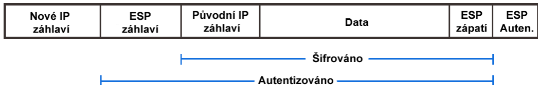
Obrázek 3.4: Struktura zapouzdření dat v ESP módu
