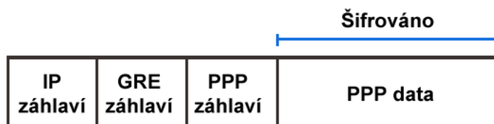
Obrázek 3.8: Struktura zapouzdření dat protokolem PPTP
