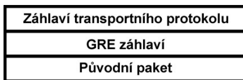
Obrázek 3.5: Struktura GRE zapouzdření
