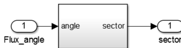
Obr. 12: Blok simulačního modelu určení sektoru, ve kterém se nachází vektor magnetického toku.
