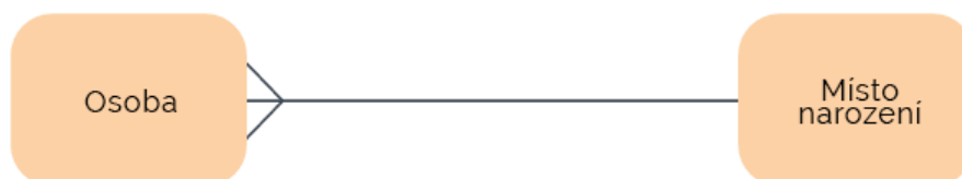
Obrázek 9: Příklad Barkerovy notace [6]
