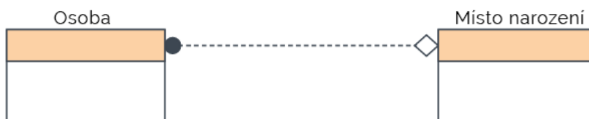
Obrázek 13: Příklad IDEF1X notace [6]
