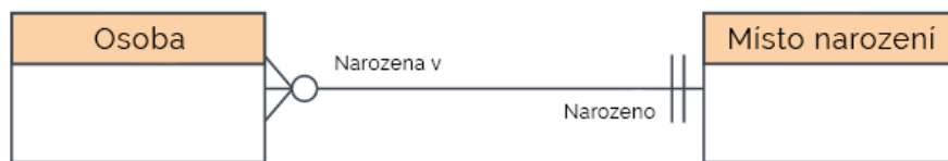
Obrázek 8: Příklad Crow's foot notace (Zdroj: [6])
