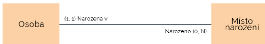
Obrázek 12: Příklad Min-Max notace [6]
