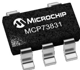
Obrázek 20 Integrovaný obvod MCP73831 [14]
