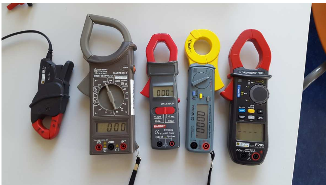
Obrázek 19 Použité měřicí multimetry (zleva MN 71, Mastech M266F, Range RE9030, Prova 23, Chauvin Arnoux F205)
