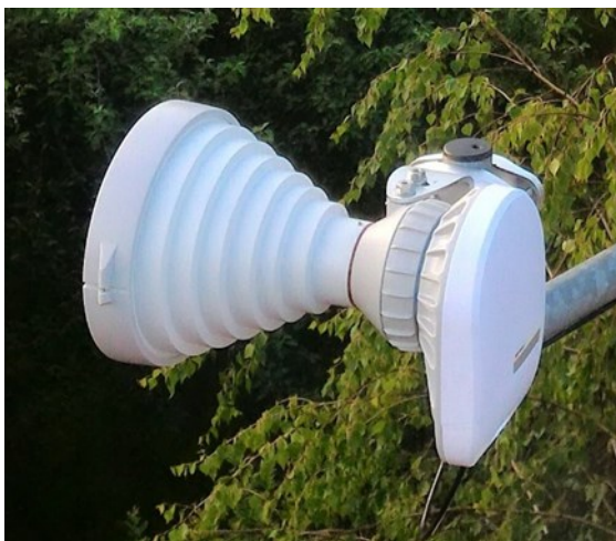
Obrázek 3.2: Anténa RFE SH-TP 30 s osazeným Twistport adaptérem
