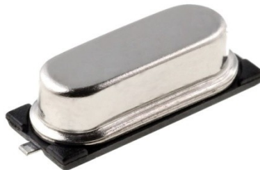
Obr. 9 Puzdro kryštálu HC49/USSMD Q 16.00MHz použitého v práci
