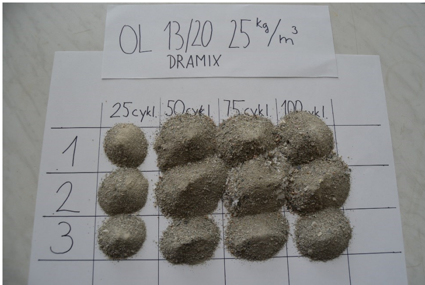
Příloha 3: Tělesa s vlákny OL 13/20 25 kg.m 3 po zkoušce CHRL a jejich odpady
