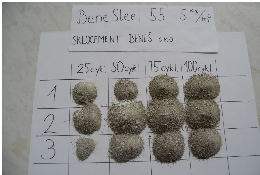
Příloha 7: Tělesa s vlákny BeneSteel 55 5 \text{ kg/m}^3 po zkoušce CHRL a jejich odpady
