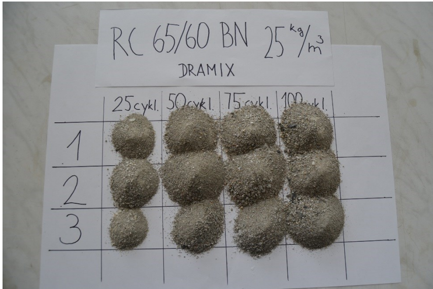
Příloha 2: Tělesa s vlákny RC 65/60 BN 25 kg.m 3 po zkoušce CHRL a jejich odpady
