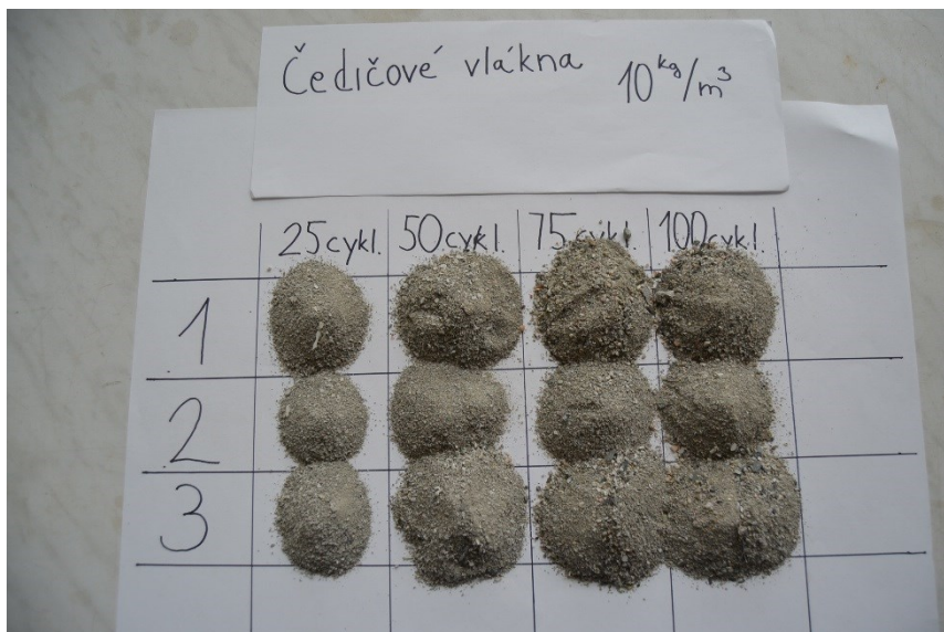
Příloha 10: Tělesa s čedičovými vlákny 10 kg.m 3 po zkoušce CHRL a jejich odpady
