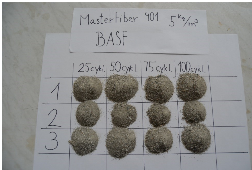
Příloha 9: Tělesa s vlákny MasterFiber 401 5 kg.m 3 po zkoušce CHRL a jejich odpady
