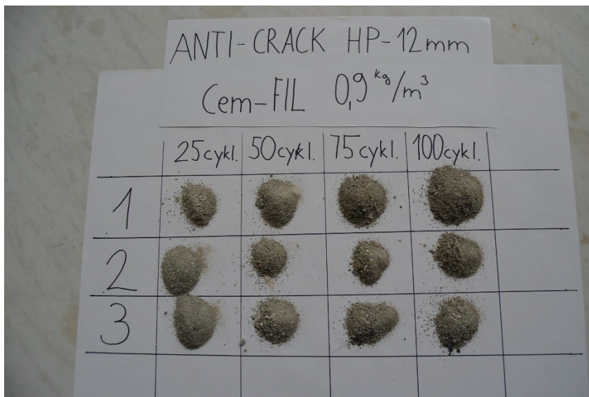
Příloha 5: Tělesa s vlákny AC-HP 12 - mm 0,9 kg.m 3 po zkoušce CHRL a jejich odpady
