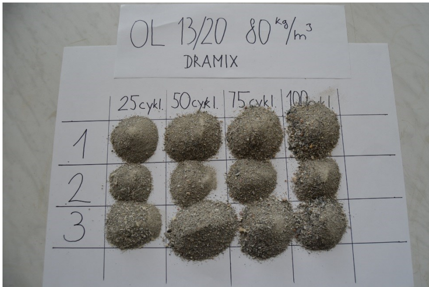
Příloha 4: Tělesa s vlákny OL 13/20 80 kg.m 3 po zkoušce CHRL a jejich odpady
