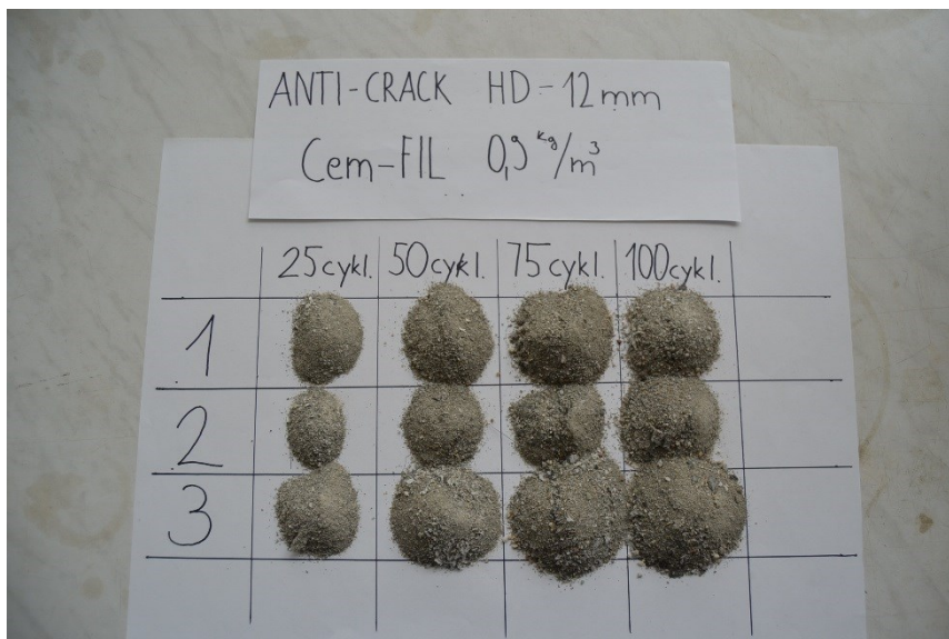
Příloha 6: Tělesa s vlákny AC-HD 12 - mm 0,9 kg.m 3 po zkoušce CHRL a jejich odpady
