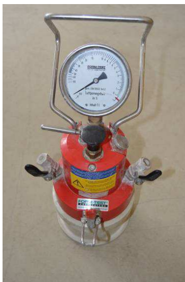
Obrázek 9: Nádoza pro stanovení obsahu vzduchu v čerstvé maltě
