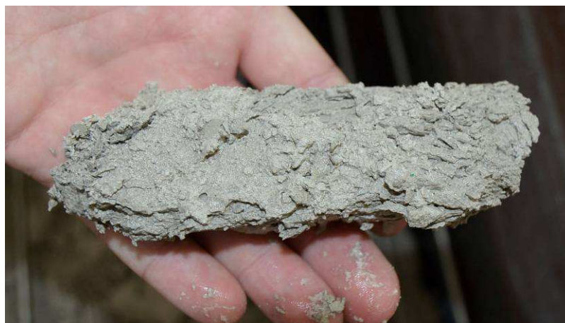
Obrázek 21: Detailní pohled na vzorek Vicat po 25 mrazících cyklech
