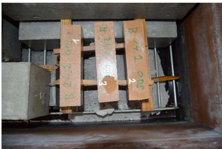
Obrázek 19: Vzorky umístěné ve zkušebním zařízení po 25 cyklech
