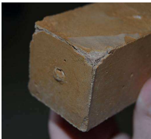
Obrázek 20: Detailní pohled na vzorek Belit po 25 mrazicích cyklech
