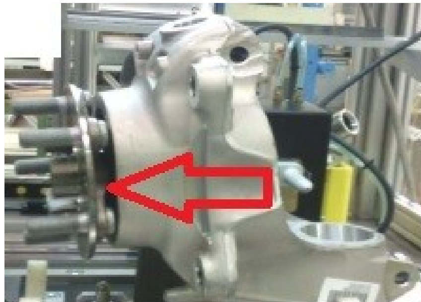
Obr. 25 Místo pro vložení kleští pro demontáž pojistného kroužku
