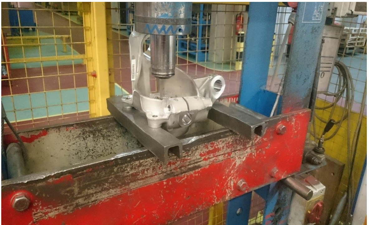
Obr. 14 Ustavení těhlice na lisu
