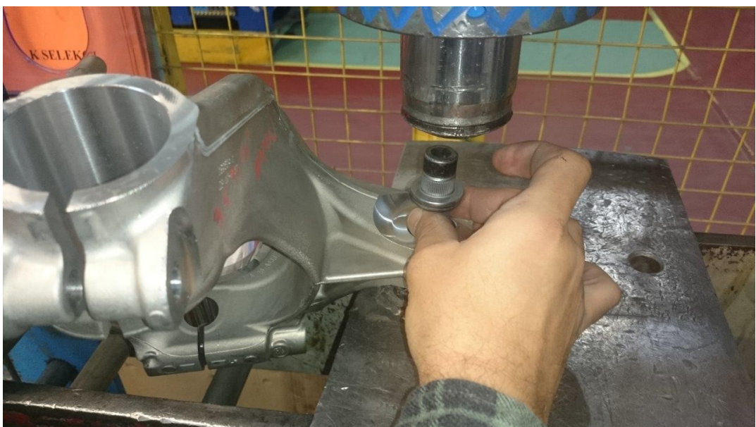
Obr. 16 Vylisování ocelové vložky
