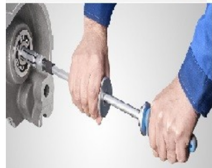
Obr. 18 Mechanické stahováky (shora) - Vnější stahovák, vnitřní stahovák, Vnitřní stahovák SKF [14], [15]
