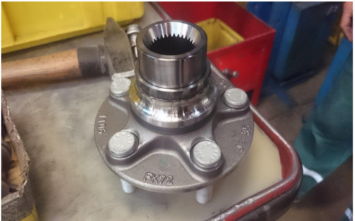
Obr. 15 Demontovaný náboj s polovinou vnitřního kroužku ložiska
