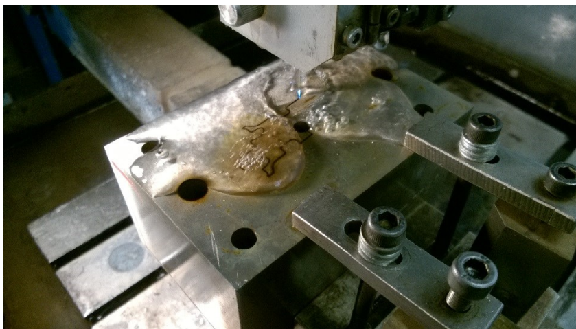
Obr. 25 Hrubování střížného otvoru
