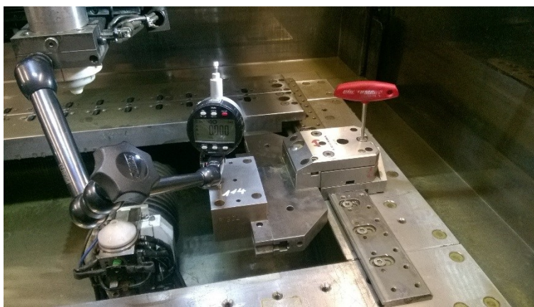
Obr. 29 Upnutí obrobku a kontrola rovinnosti
