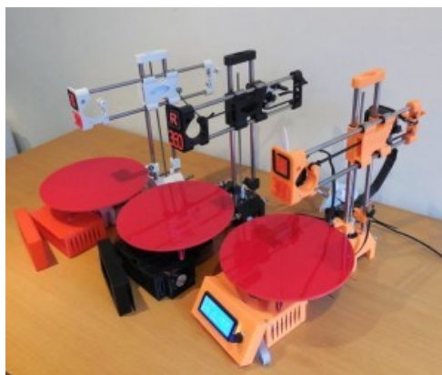
Obr. č. 4 - 3D tiskárny typu Polar [14]
