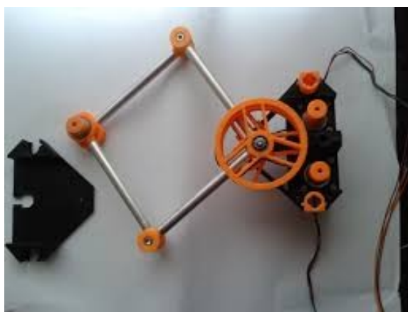
Obr. č. 5 - 3D tiskárna typu Scara [14]
