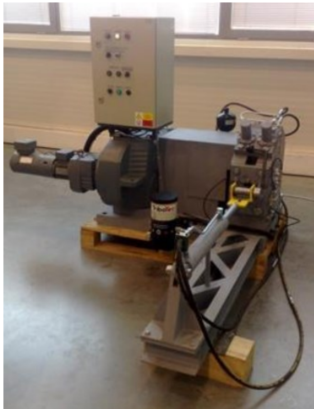
Obr. 14 Tvářecí zařízení využívající metodu DRECE[11].
