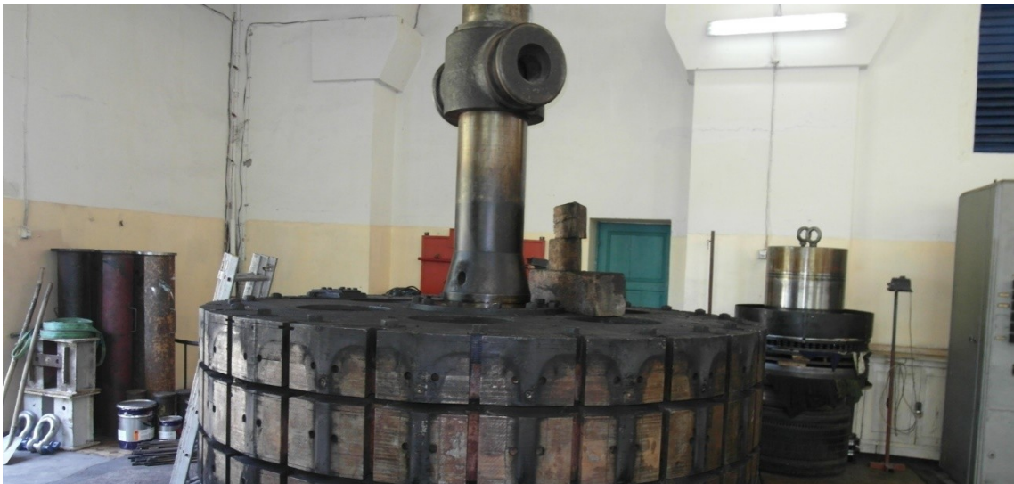
Obr. 2.4 Magnetové kolo na hřídeli s demontovanými cívkami a transportním hřídelovým nástavcem
