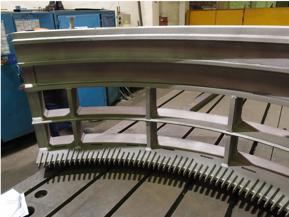
Obr. 4.1 Fotografie poloviny statorové kostry ve výrobě
