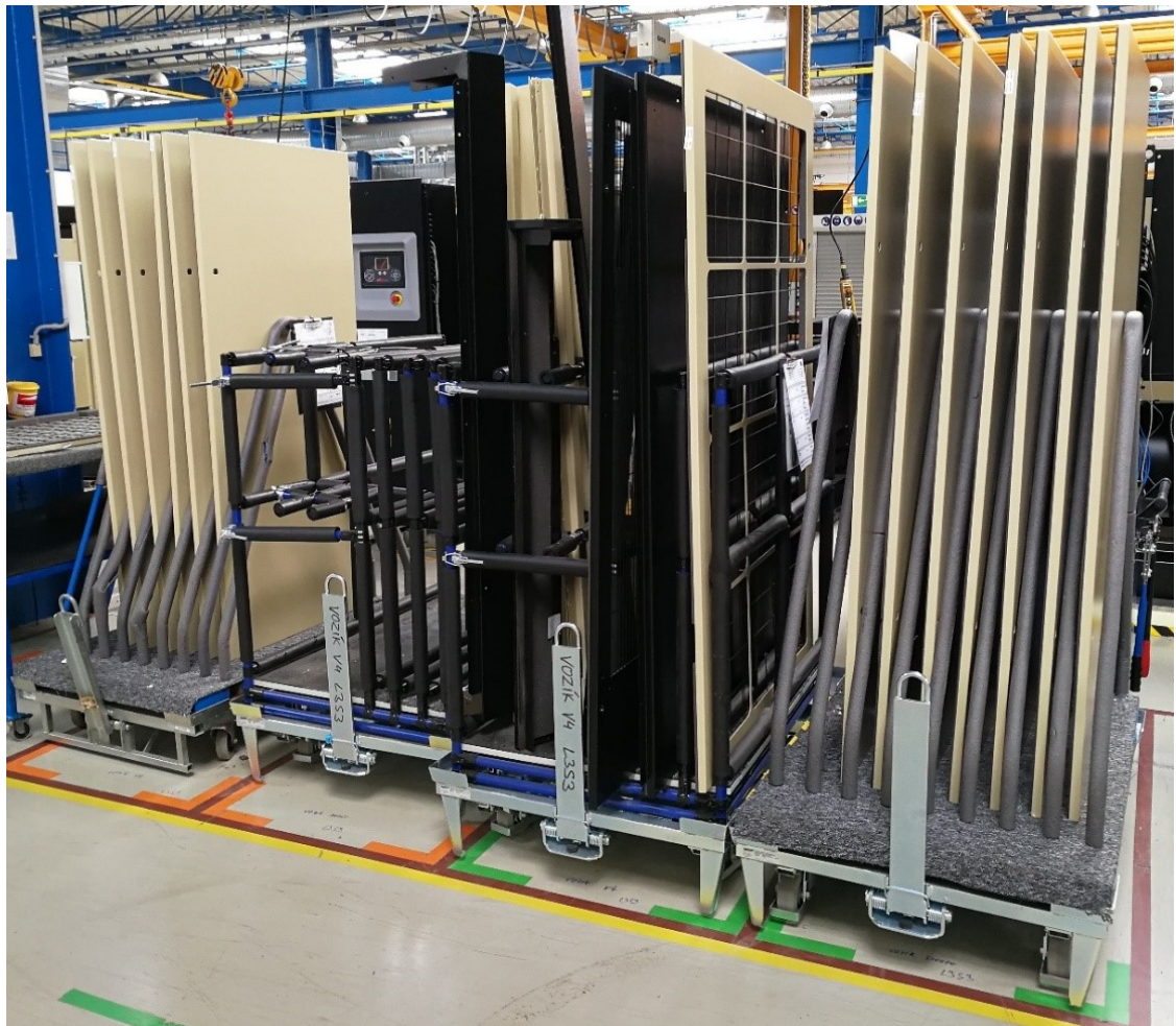
Obr. 39 Skladování materiálu na dva takty montáže (oranžová a zelená vyhrazená plocha)
