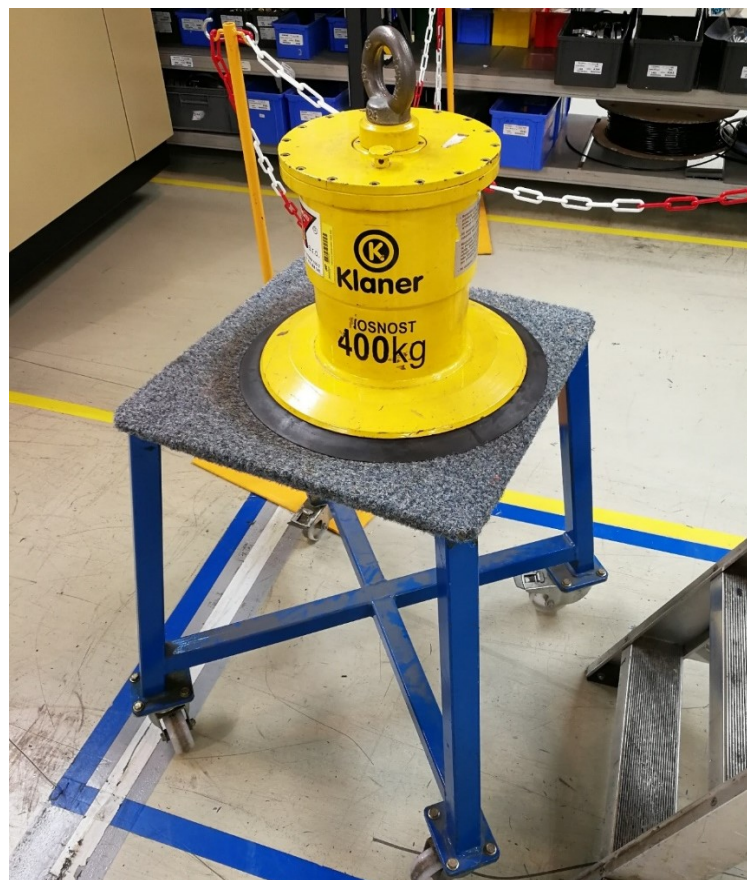
Obr. 33 Vakuový přípravek pro montáž střešních panelů
