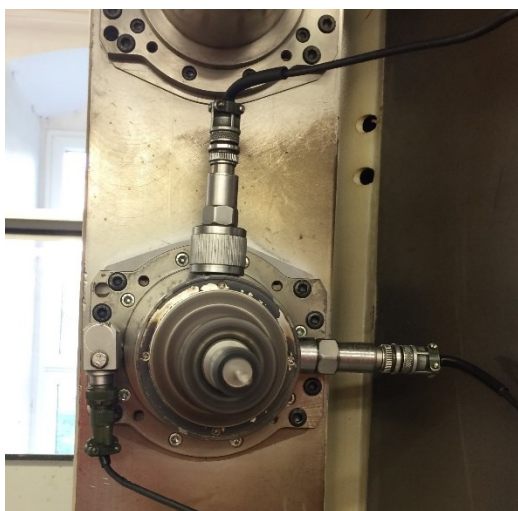
Obr. 13 Měření vibrací na stroji Multilathe 1 v bodě L4. [autor]
