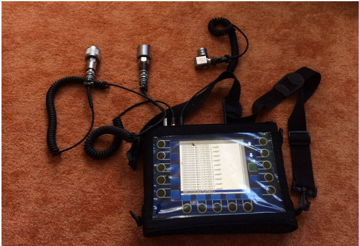
Obr. 8 měřicí přístroj Adash A4400 VA4 Pro se snímači vibrací [autor]
