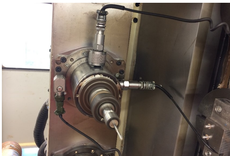
Obr. 23 Měření vibrací na stroji Multilathe 3 v bodě L3. [autor]
