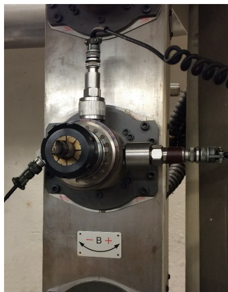
Obr. 44 Měření vibrací na stroji Multilathe 3 v bodě L3. [autor]
