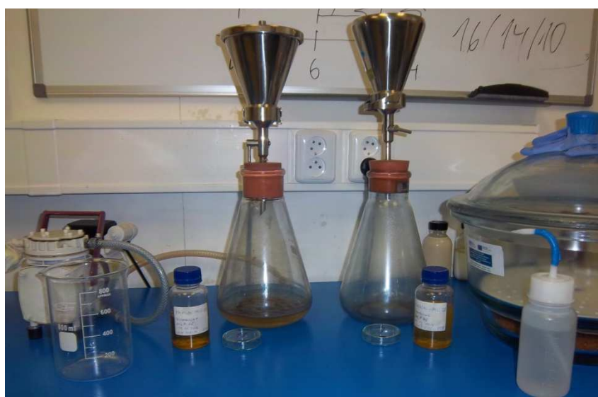
Obr. 27 – Filtrace oleje za pomoci podtlaku [autor]
