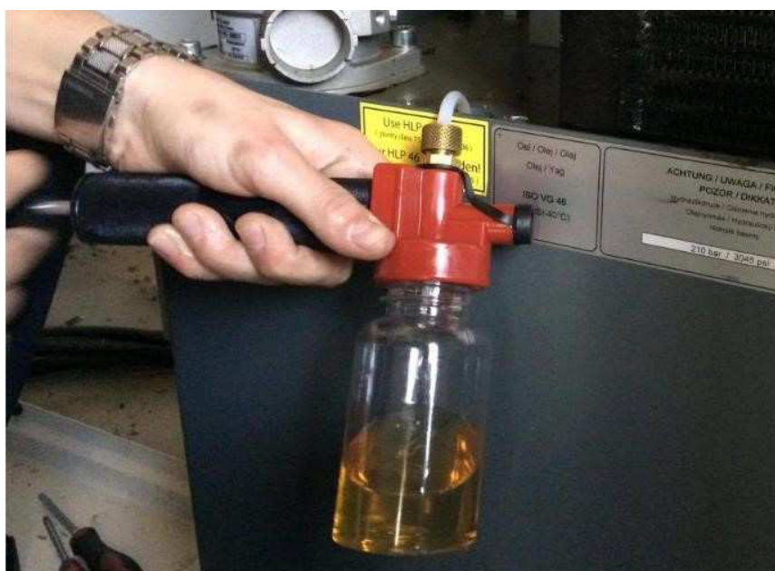
Obr. 22 – Ukázka oděru vzorku do vzorkovnice pomocí vakuové pumpy [autor]
