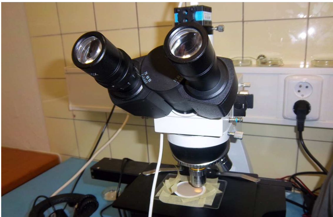
Obr. 28 – určení kódu čistoty mikroskopicky [autor]
