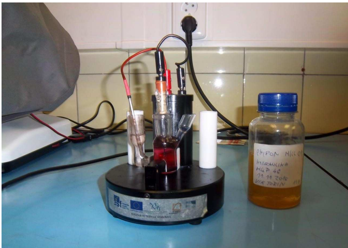
Obr. 26 – Určení čísla kyselosti za pomoci metody titrace na barevný indikátor[autor]
