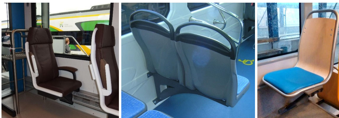
Obr. 3.5 – Varianty upevnění sedadel k boční stěně [13]
