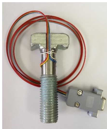
Obr. 31 – Hotový snímač připravený ke kalibraci
