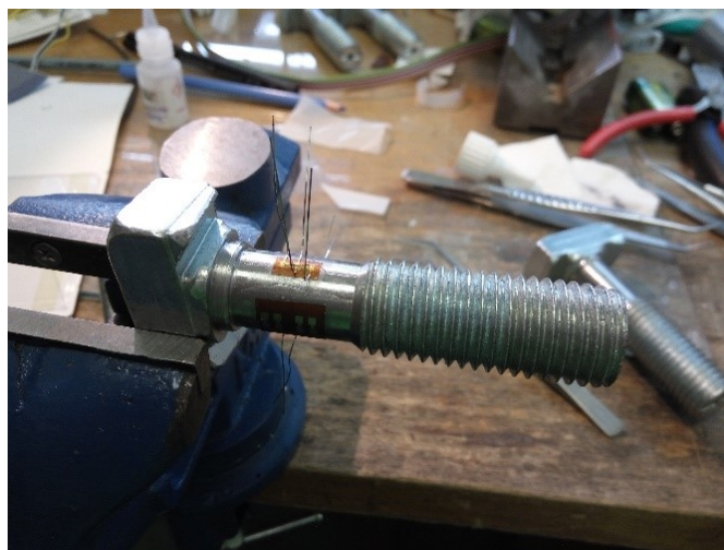
Obr. 28 – Nalepený tenzometr a patka
