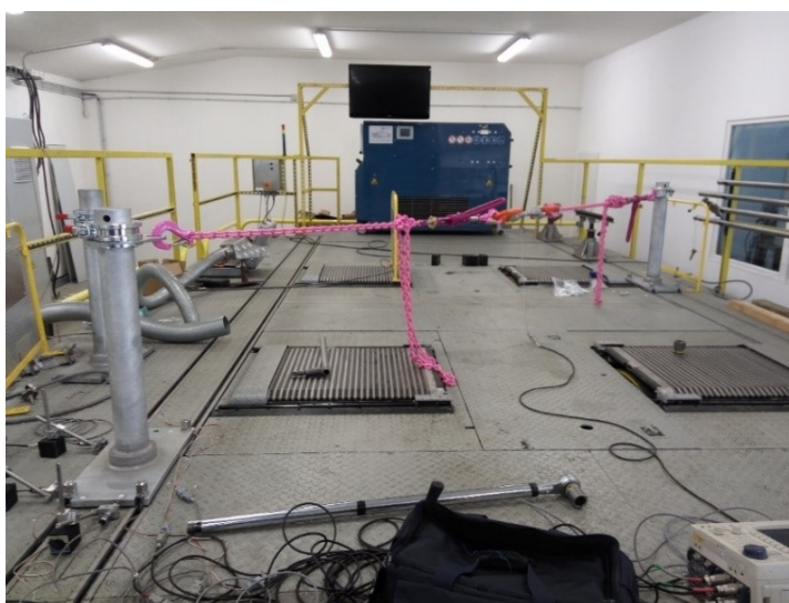
Obr. 33 – Ukázka geometrické konfigurace sloupků – 45^\circ, 730 \text{ mm}
