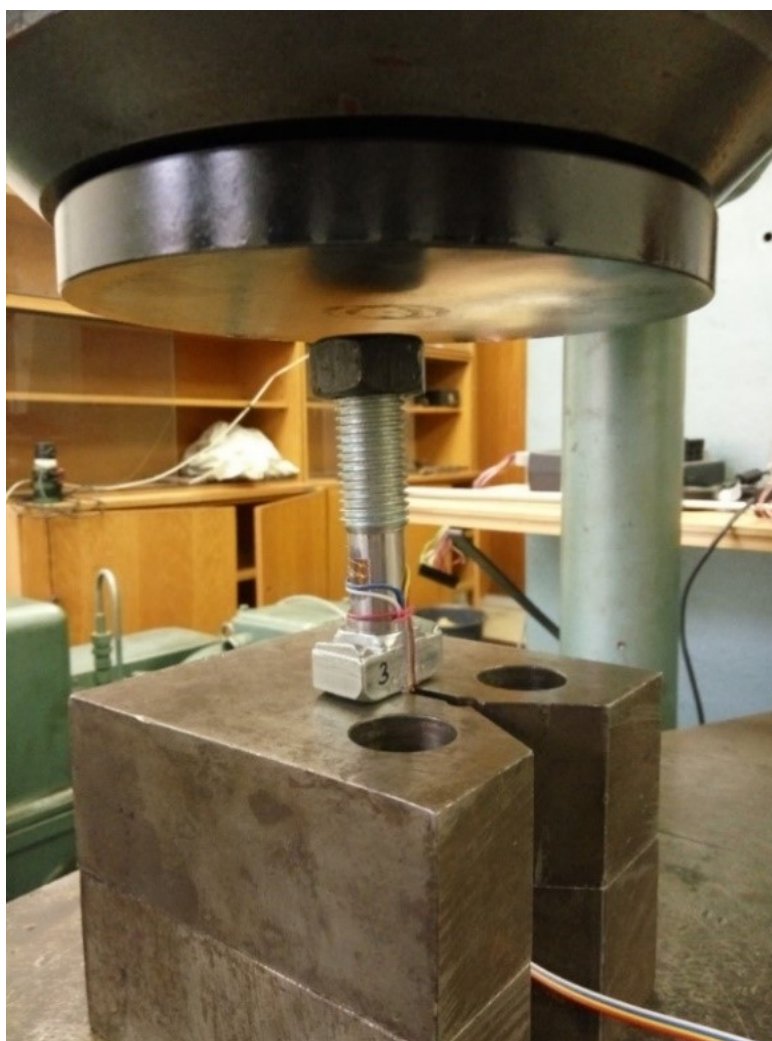
Obr. 32 – Ukázka kalibrace šroubu
