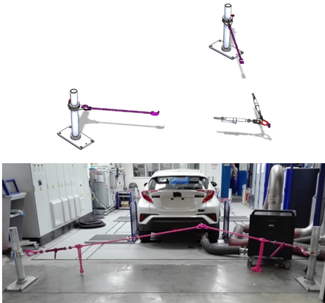
Obr. 9 – Sloupky s řetězy
