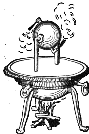
Obrázek 1: Aeolipilu Řeckého fyzika Heroná Alexandrického [3]
