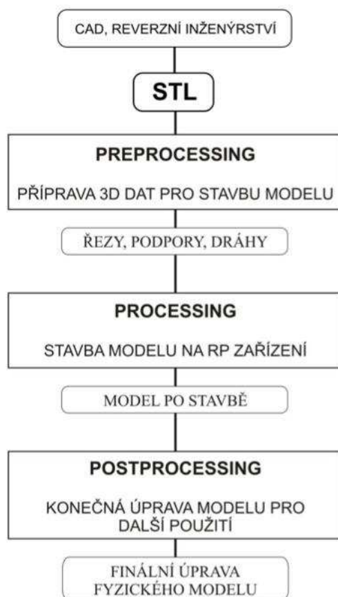
obr. 14 – Schéma procesu výroby prototypu technologie rapid prototyping [4]
