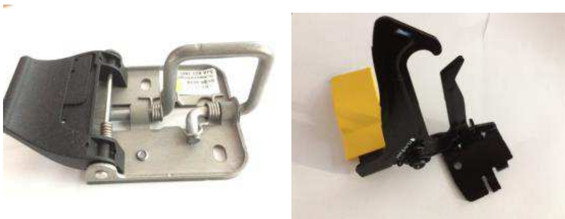
obr. 1 – výklopné háky přední kapoty
