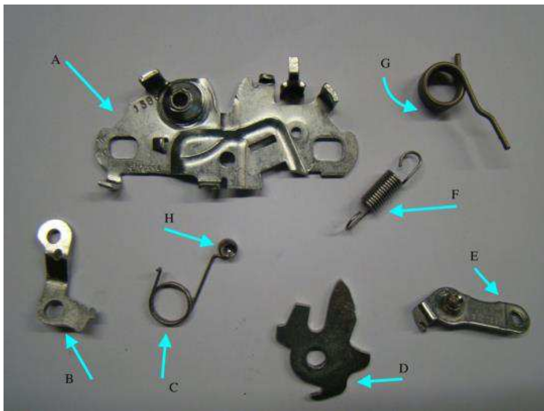
obr. 11 – rozklad zámku přední kapoty Peugeot
