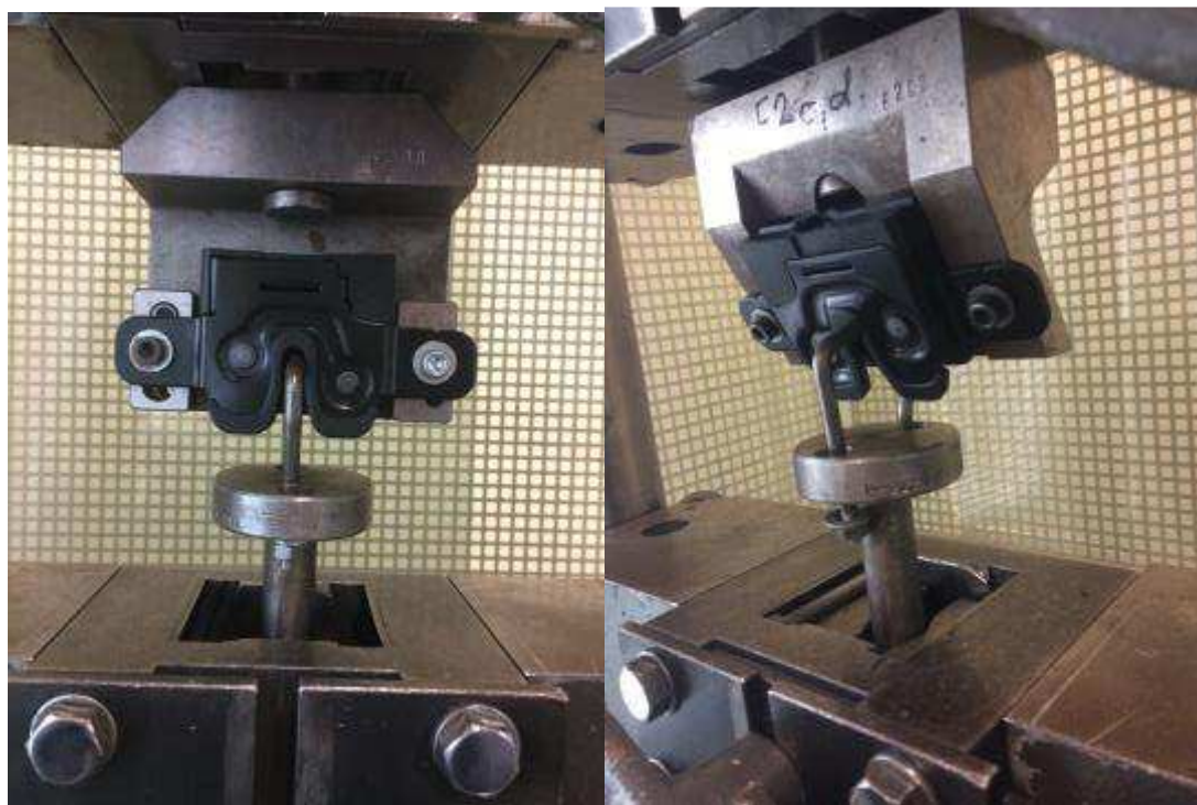
obr. 32 – Upevnění zámku na přípravek tahové zkoušky (vpravo je vertikální síla, vlevo síla otočená o 45°)
