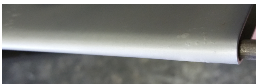
Obr. 26 – Ukázka ohybové zkoušky pro 3,2 mm průměr
