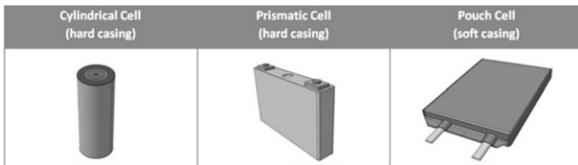
Obr. 4 Tři hlavní typy bateriových článků, používaných v automobilovém průmyslu, zleva: cylindrický, prizmatický a typu „pouch“ 7 .
