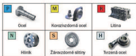
Obr. 1.1 Prehľad rozdelenia obrábaných materiálov do skupín podľa ISO 513 [6]
