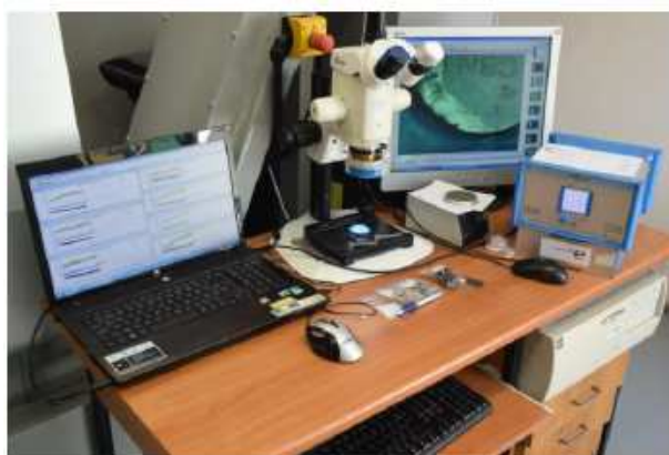
Obr. 3.8 Laboratórna zostava pre meranie opotrebovania nástrojov
