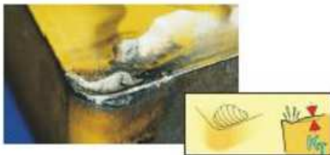
Obr. 2.15 Opatrebovanie čelnej plochy rezného klina v tvare žliabku [29]
