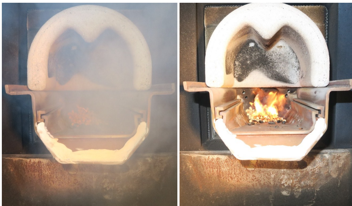
Obr. č. 5.13 vlevo 3. fáze zapalování – ohřívání vzduchu průtokem kolem a skrz keramický váleček
