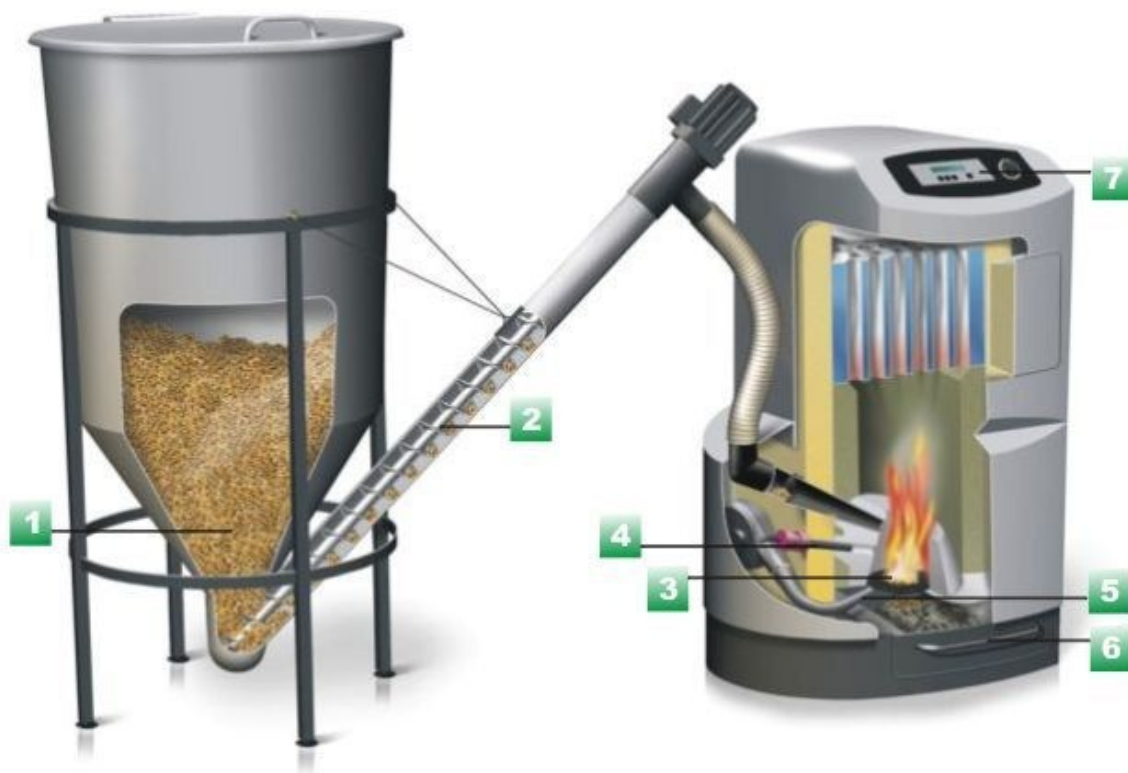
Obr. č. 3.4 Schéma sestavy kotle na pelety s okolním zařízením [41]
