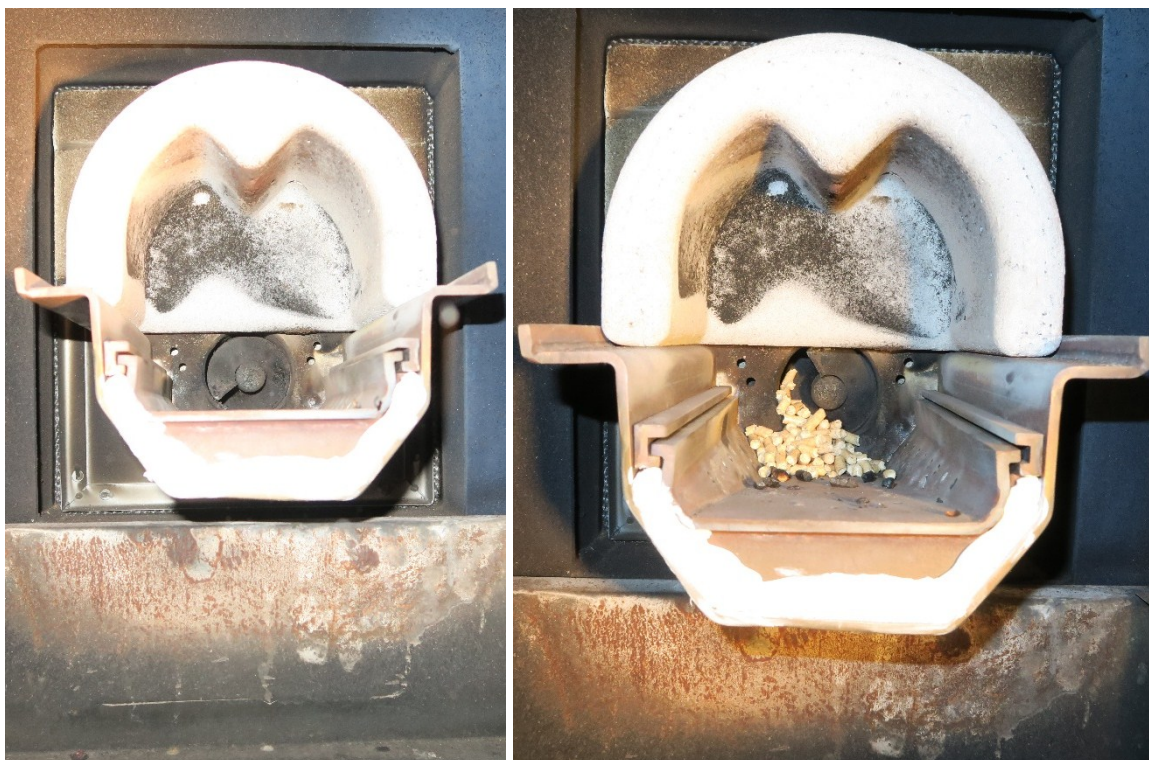
Obr. č. 5.11 vpravo 1. fáze zapalování – vyfoukávání popela z předešlého provozu
