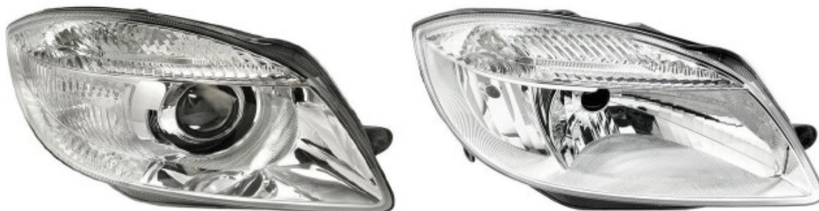
Obrázek 27: Projektorový a reflektorový typ halogenového světlometu [10]
