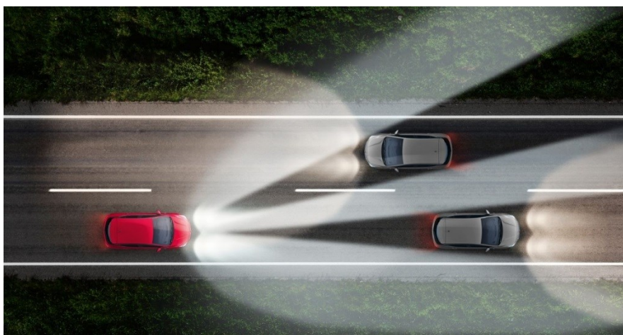
Obrázek 4: Ukázka funkce světlometu matrix v provozu [5]
