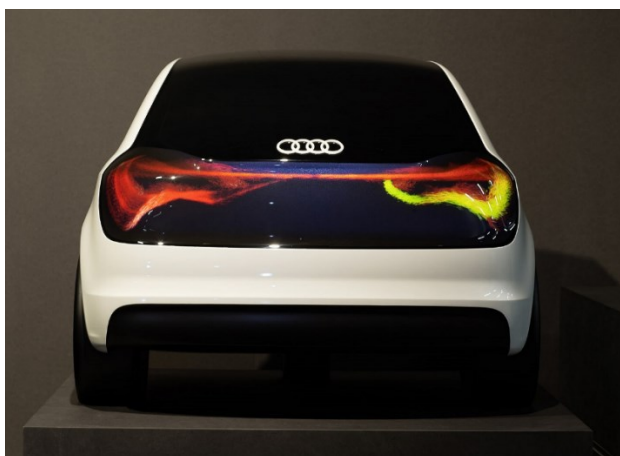
Obrázek 6: Moderní OLED obrazovka jako zadní světlomet [28]
