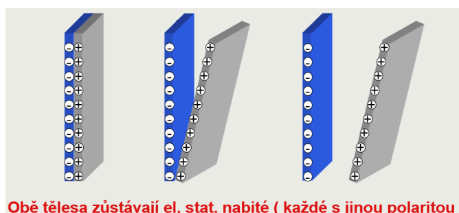
Obrázek 45: Princip nabití materiálu vodivým nábojem [5]
