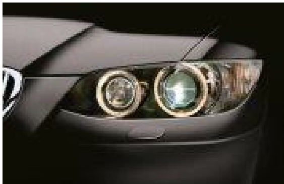
Obrázek 18: Příklad použití světlovodů ve světlometu BMW [7]
