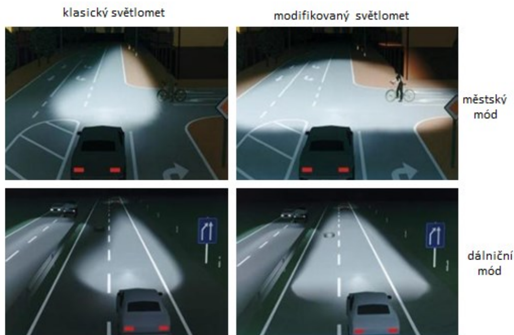
Obrázek 33: Rozdíl mezi klasickým a modifikovaným světlem [23]
