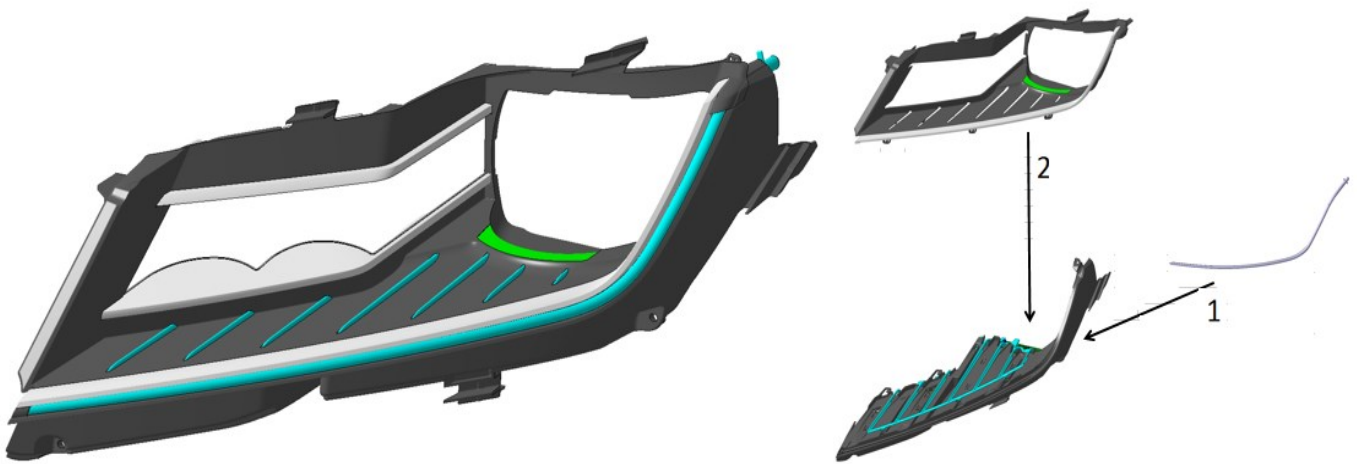
Obrázek 71: Spojení dvou skupin z předešlé montáže ve skupinu hlavního LED rámu
