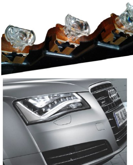
Obrázek 30: Flexibilní vodivý pás LED a ukázka jeho svícení ve světlometu [10]
