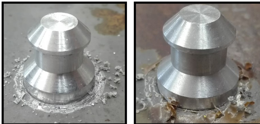
Obr. 23 Plastická tříška u nové nátěrové hmoty (vlevo) a drobná šupinková tříška u staré nátěrové hmoty (vpravo)
