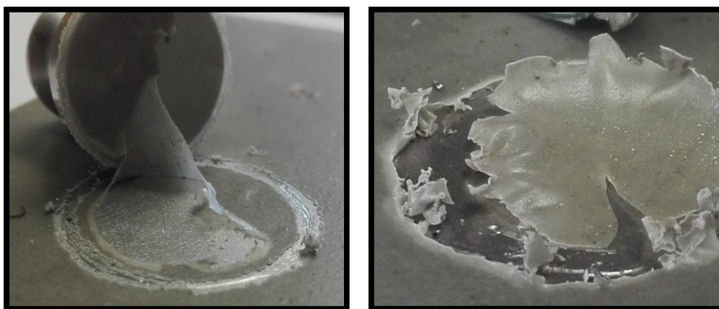
Obr. 22 Plastické vlastnosti v průběhu odtrhové zkoušky v 35 dnu exponování u nové nátěrové hmoty (vlevo) a staré nátěrové hmoty (vpravo)
