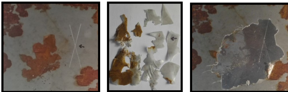
Obr. 25 Vzorek s novou nátěrovou hmotou (vlevo), odstraněný nový nátěr (vprostřed), podkladový materiál po odstranění nové nátěrové hmoty (vpravo)
