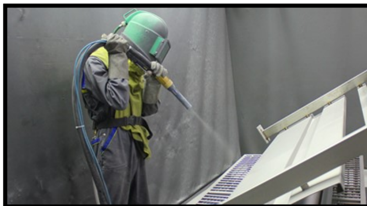
Obr. 4 Otryskávání součásti tryskacím zařízením firmy Stauber [8]
