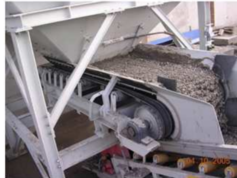
Obr. 12 - Pásový podavač PPV – technická data, fotografie 100x260 [7]
