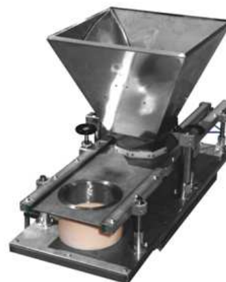
Obr. 5 - Šoupátkový podavač DS1 - technické parametry, fotografie [3]
