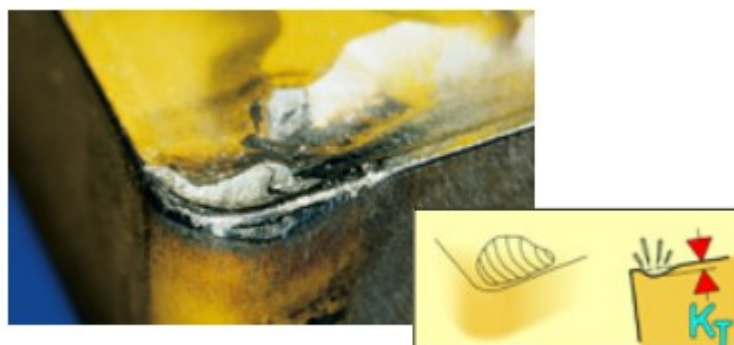
Obr. 6: Vliv difuze na čelo břitu [6]
