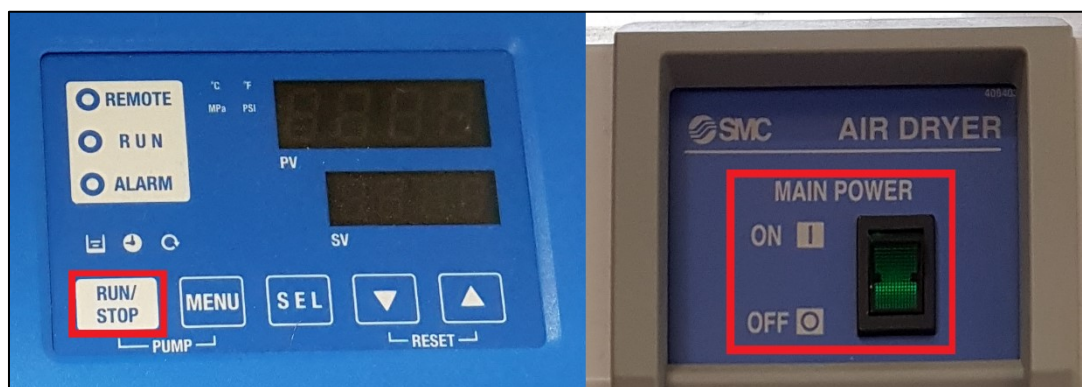
Obr. 28 – Zapnutí chladiče (vlevo) a odvlhčovače (vpravo)
