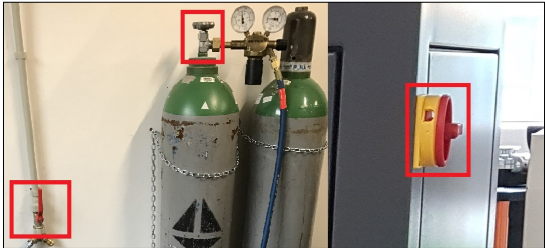
Obr. 29 – Otevírání uzávěru na lahvích s argonem, přívodu kyslíku (vlevo) a přepnutí hlavního spínače (vpravo)
