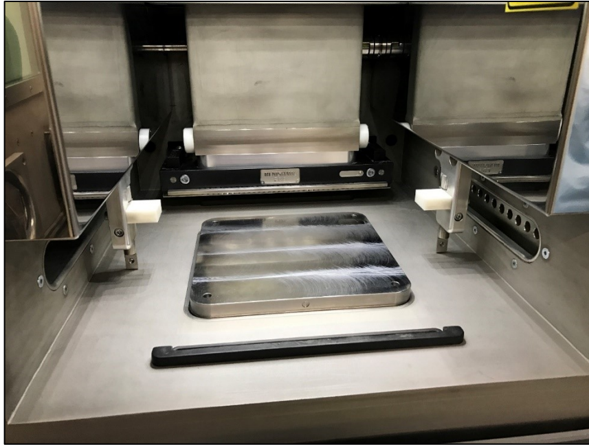
Obr. 6 – Pracovní komora 3D tiskárny Renishaw AM400
