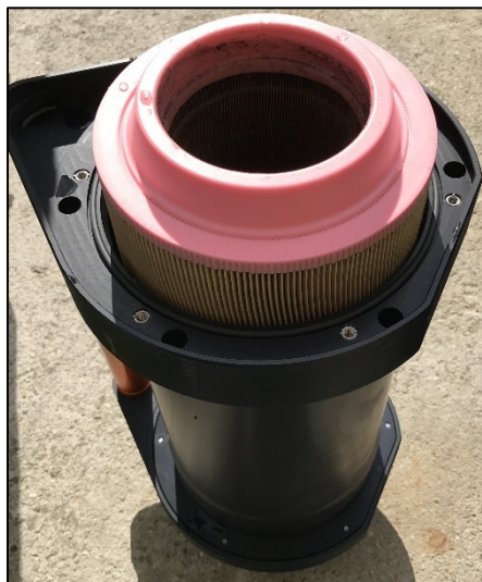
Obr. 20 – Ochranná nádoba s filtrem již bez horního víka
