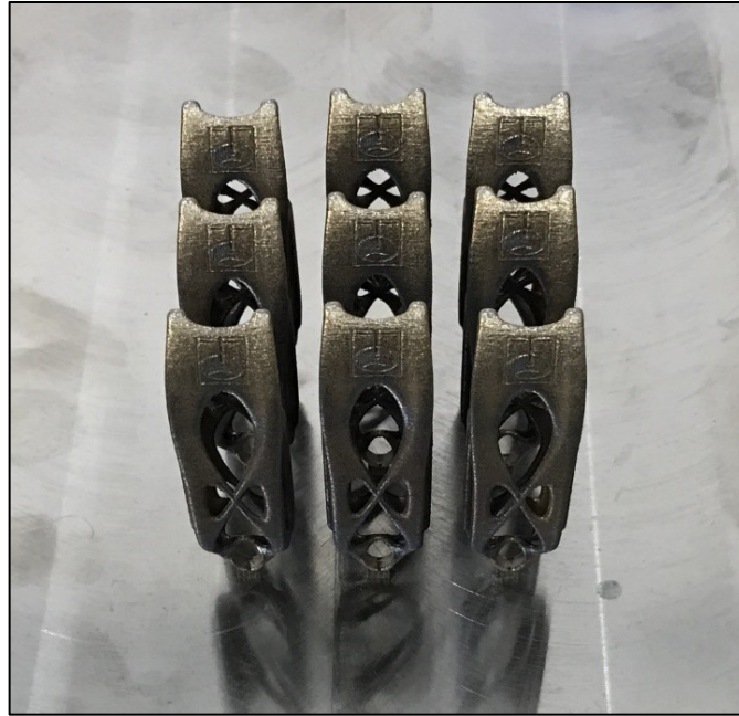
Obr. 7 - Vytištěné kovové součásti pomocí 3D tiskárny metodou SLM
