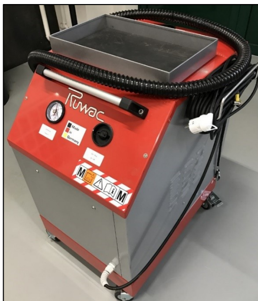
Obr. 14 – Mokrý odlučovač ATEX od firmy Ruwac, model NA7
