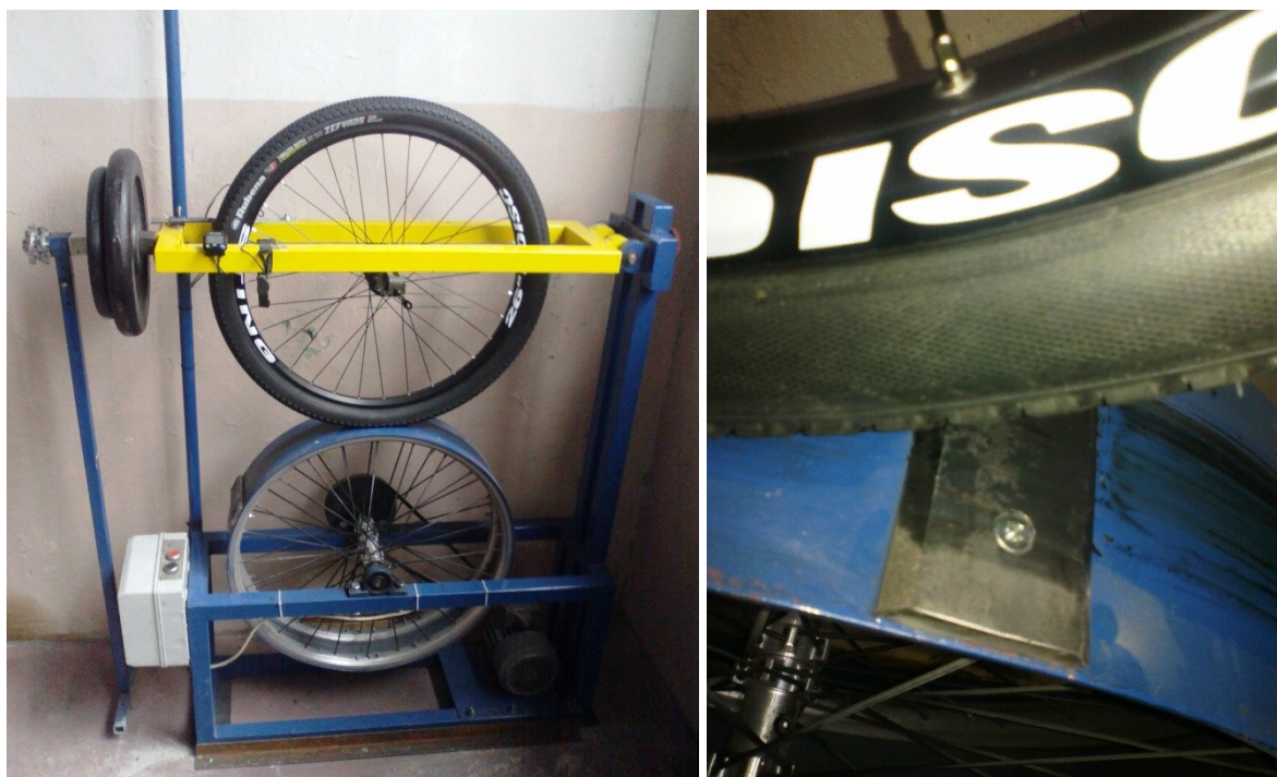
Obrázek 18 - Únavová zkouška a detail překážky [18]
