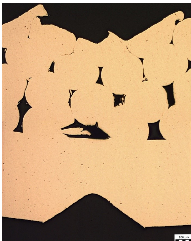
Obrázek 23–Kabel o \varnothing 2,5 mm bez stříbření v místě svaru zvětšení 60x v řezu
