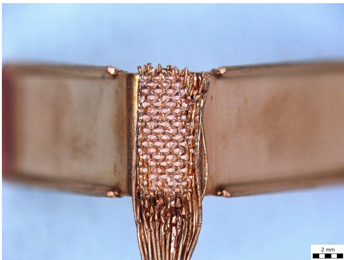
Obrázek 21–Kabel o \varnothing 2,5 mm bez stříbření v místě svaru zvětšení 5x
