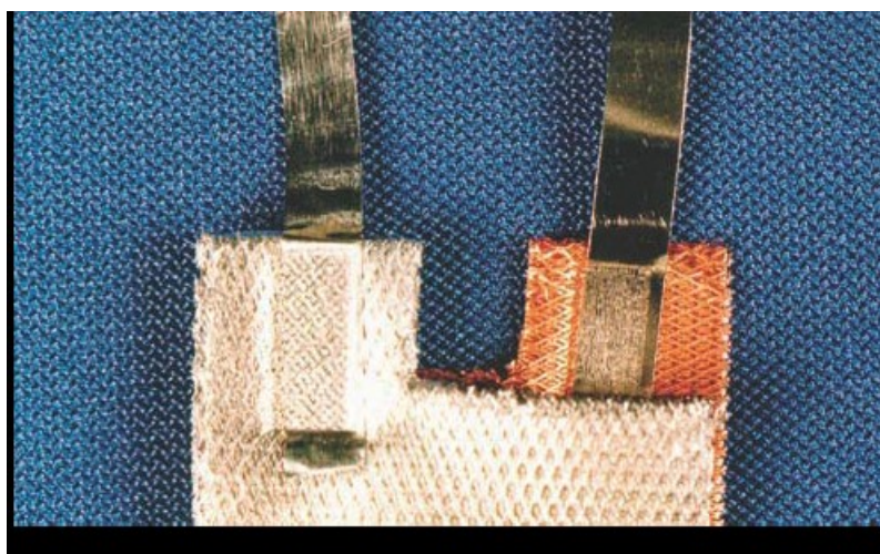
Obrázek 9 - Svařený hliníkový a niklový plát s navařenými měděnými vodiči, "vnitřek baterie" [1]
