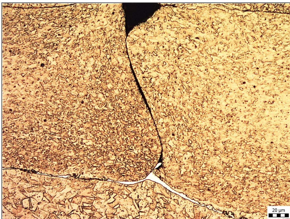
Obrázek 34–Kabel o \varnothing 4 mm se stříbřením v místě svaru zvětšení 450x po naleptání
