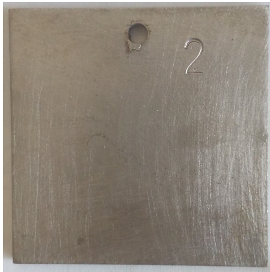
Obr. 20 Vzorek č. 2 z oceli 11 321
