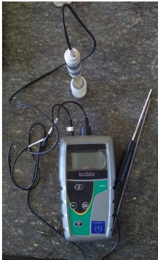
Obr. 18 Měřič pH a teploty EUTECH pH 5+
