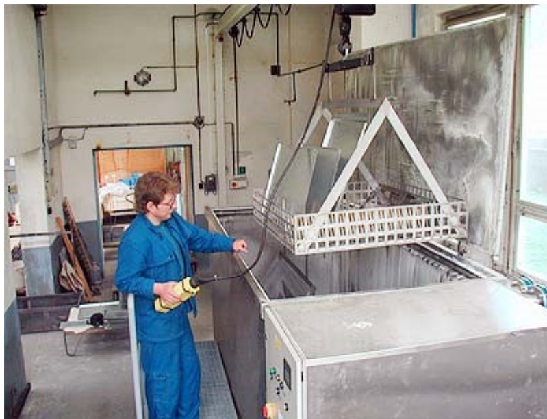
Obr. 8 Vanový odmašťovací stroj [8]
