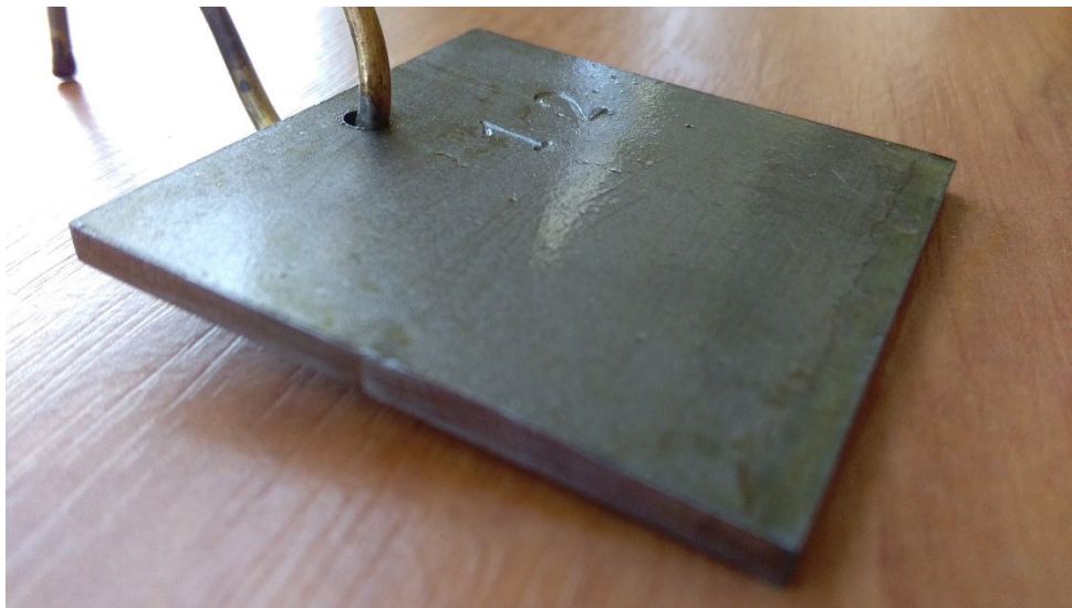
Obr.27 Mastný vzorek po odmaštění v koncentraci 1:150
