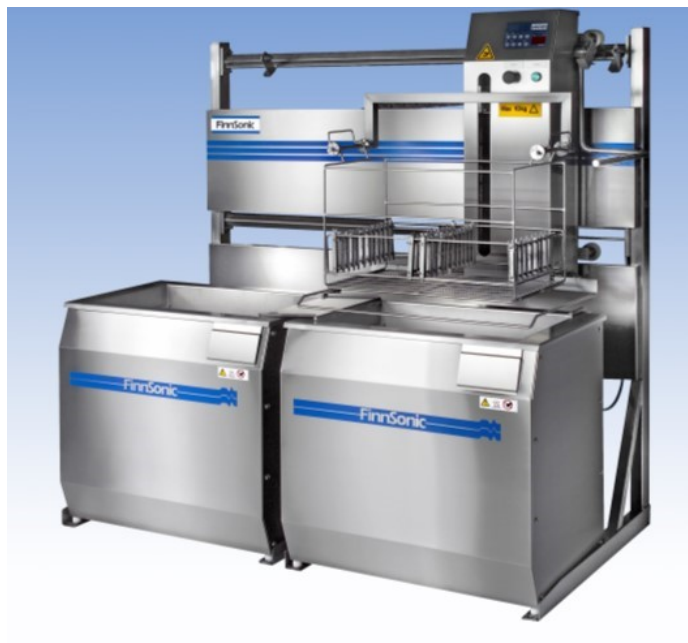
Obr. 11 Ultrazvuková vana s oplachem a automatickým zdvihem [11]
