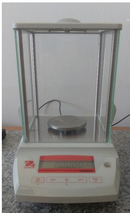
Obr. 17 Digitální analytické váhy OHAUS Pioneer PA214C
