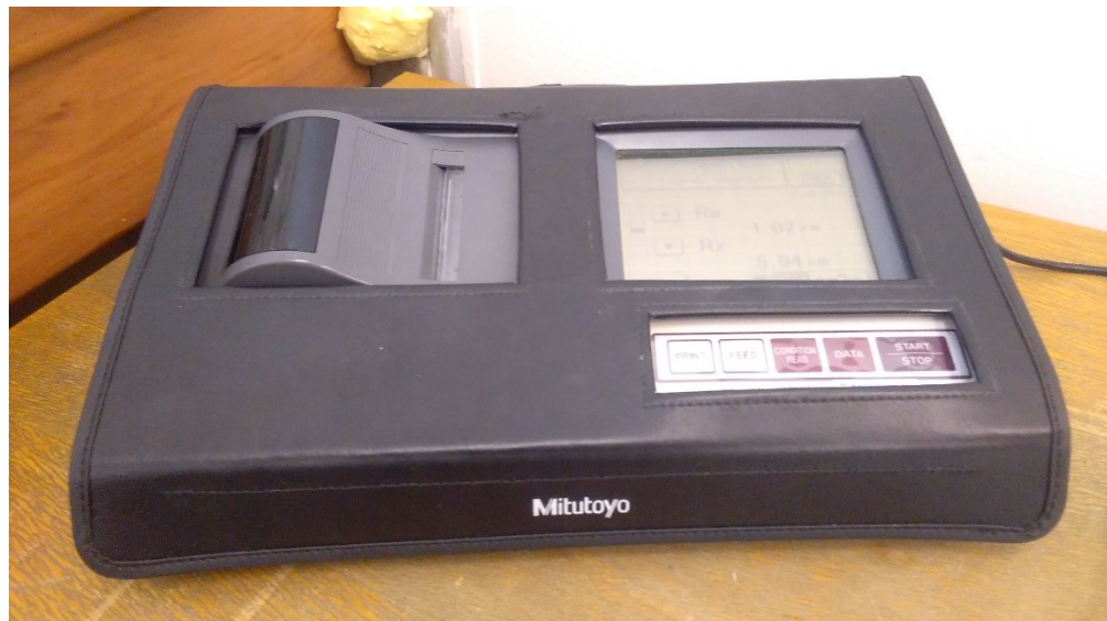
Obr. 16 Měřič drsnosti Mitutoyo SJ-301
