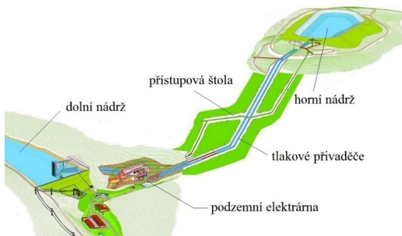
Obr. 7 Schéma přečerpávací vodní elektrárny Dlouhé stráně [23]
