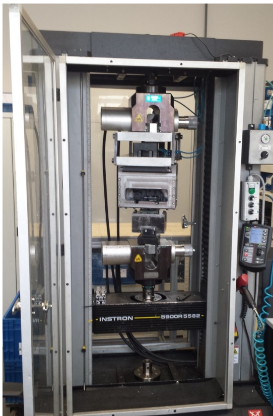
Obr. 1: Zařízení pro trhací testy + stranový zámek po trhacím testu
