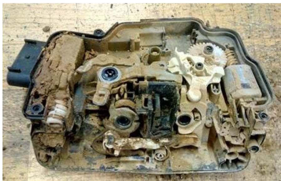
Obr. 9: Reálný zámek zanesený pískem
