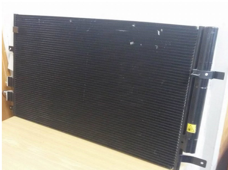
Obr. 3.8: kondenzátor klimatizace pro chladivo R134a [zdroj: viz autor BP]
