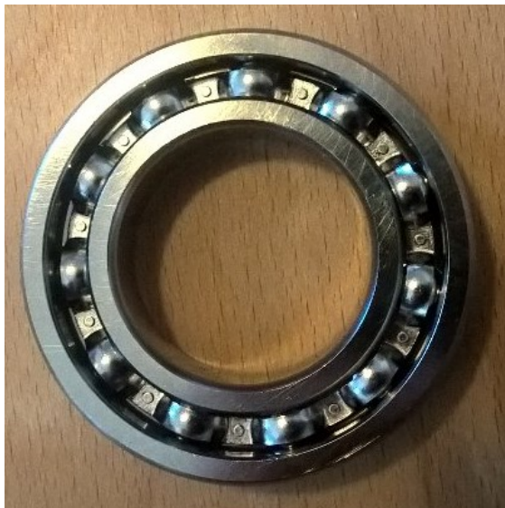
Obr. č. 2 – Jednořadé kuličkové ložisko ZKL6003 před vyjmutím klece
