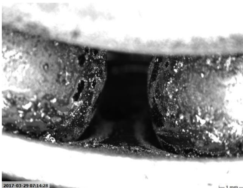
Obr. č. 5 – Pohled na nerovnoměrnosti povrchu ložiskové klece mezi lůžky pro kuličky po zahřátí na 600°C na 1 hodinu
