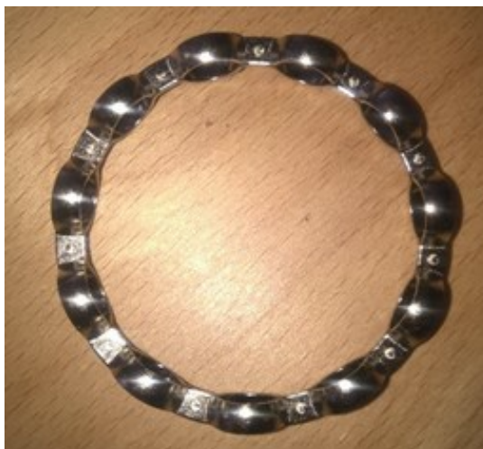
Obr. č. 3 – Ložisková klec vyňatá z ložiska ZKL6003
