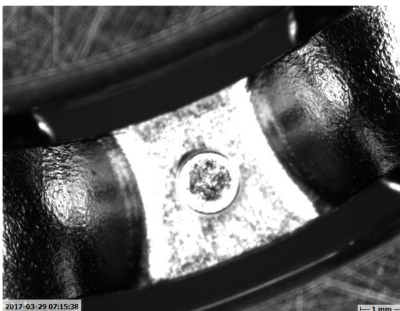
Obr. č. 4 – Pohled na nýt mezi lůžky pro kuličky u ložiskové klece s právě provedenou povrchovou úpravou chemický nikl
