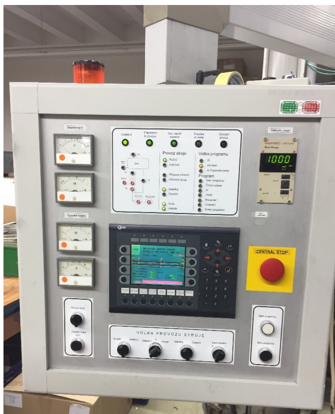
Obrázek 13 - Ovládací panel vakuové kovičky
