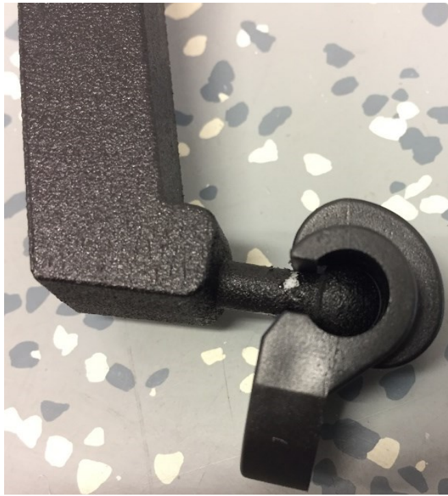
Obrázek 32 - Srovnání povrchů prototypu (vlevo) a sériového kusu (vpravo)
