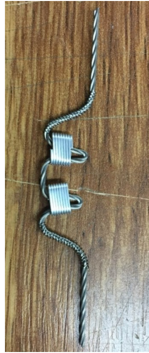
Obrázek 37 - Hliník na wolframovém meandru
